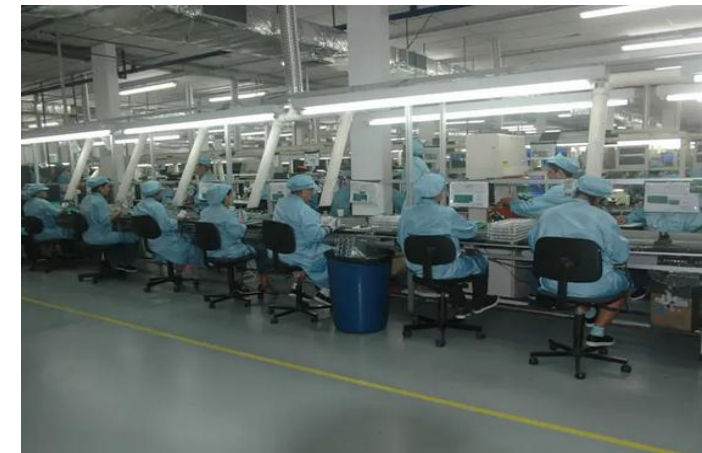
Inserção manual de componentes eletrônicos em placas de circuito impresso.
