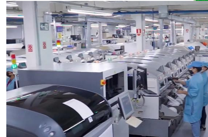
Inserção automática de componentes eletrônicos em placas de circuito impresso.
